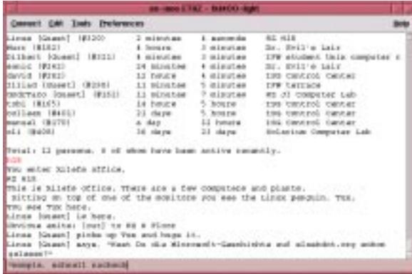
**telnet:** telnet ee-moo.ethz.ch 8092 (8092 entspricht der Portnummer und entspricht zum einfacheren Merken der Postleitzahl der ETH). Dies ist die einfachste Möglichkeit, die immer funktioniert, denn praktisch jedes System enthält heute einen telnet-Client. Dies ist aber nicht ganz so komfortabel bzw. sieht etwas unschön aus, da sich Ausgaben des Systems und Eingaben des Benutzers überschneiden.
