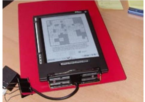
*iLiad mit Travel Hub und selbst gebasteltem 5CHF-Workaround für den defekten Steckersockel*
