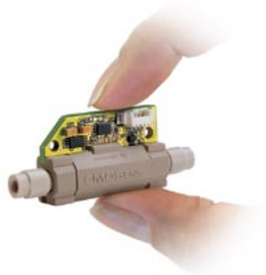
Liquid Flow Sensor LG16 für die medizinischen Diagnostik. Auflösung: 0.5 Nanoliter/Minute
