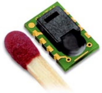
Digitaler Mikrosensor SHT11 zur Messung relativer Feuchte
